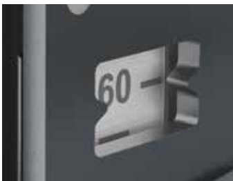
Höhenmarkierung manuell auf Aluskala (Standard). Die Skala ist höhenverstellbar zur Anpassung an die Kfz-Stellflächenhöhe.
