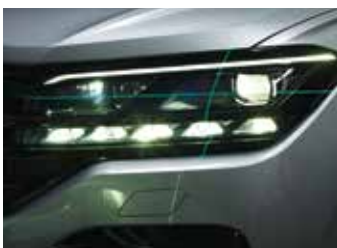
Kreuzlaser: Ausrichtung zur Scheinwerfermitte
