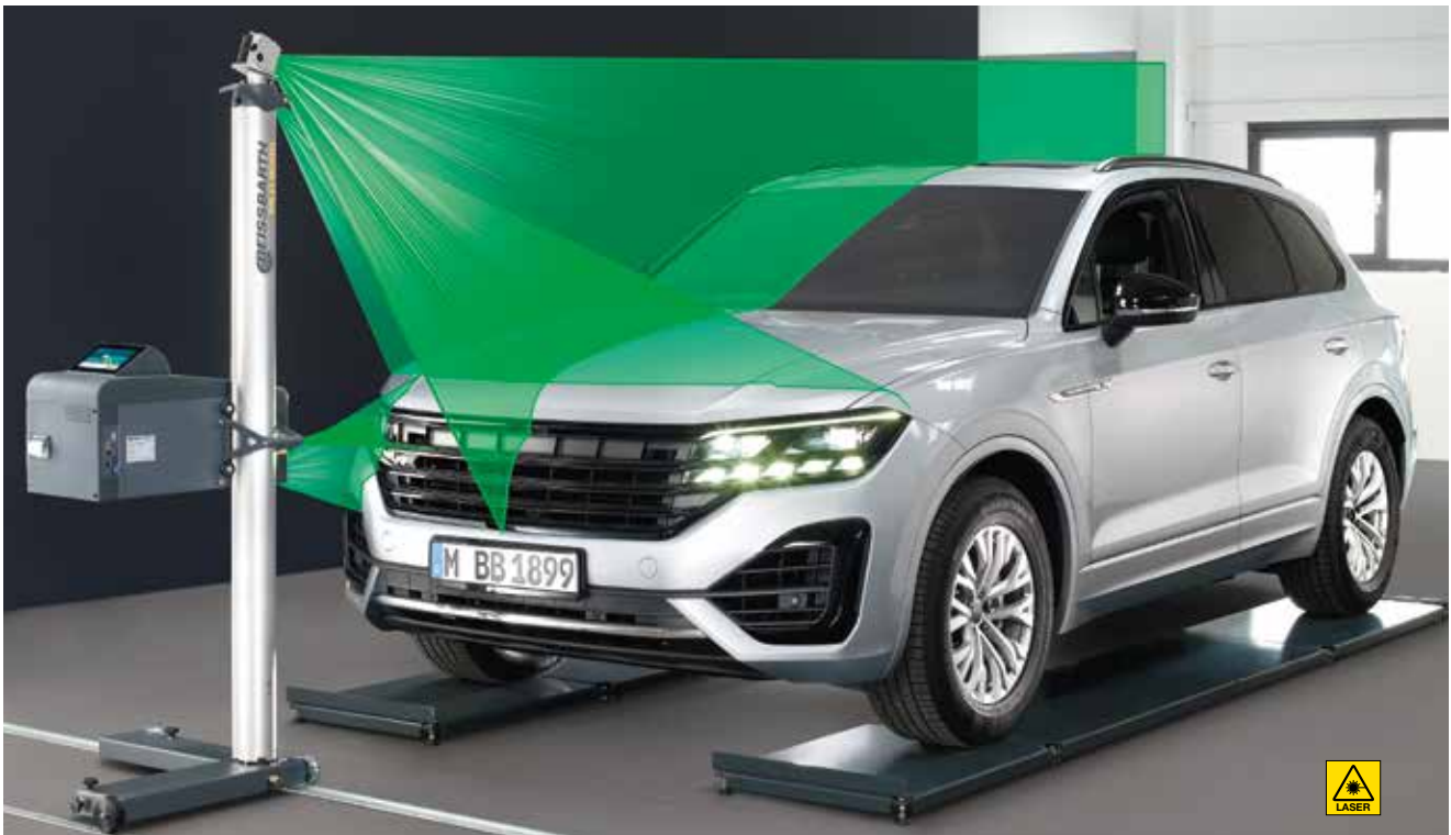
Digitale Scheinwerfereinstellung mit 4 Lasern
