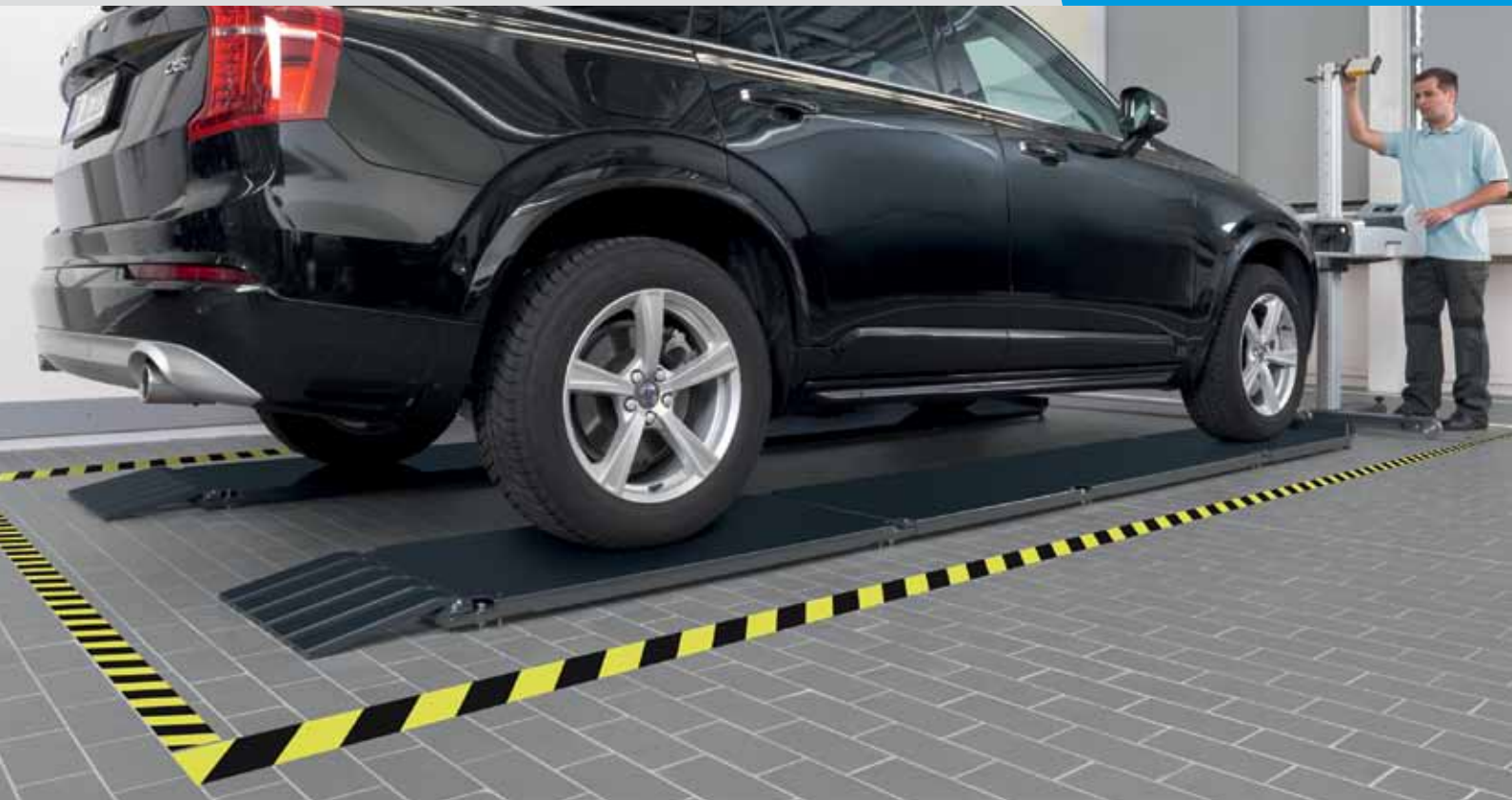
LTB 100: Standard-Lieferumfang 4 m (Abb. mit schienengeführten, digitalem Scheinwerfer-Einstellgerät MLD 815)
