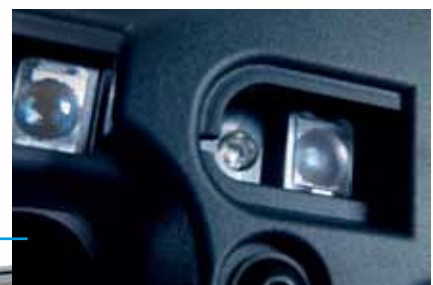
Beissbarth-Referenzsystem mit 2 Kameras pro Messwertaufnehmer
